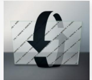
**3** Introduzca la hoja así girada de nuevo en la cortadora de vidrio (sin cambiar las medidas), pase a la cuchilla para vidrio y siga la misma línea para trazar la línea de ruptura por el lado del vidrio.
